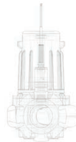
Vertikale Aufstellung, z.B. im Pumpenschacht
